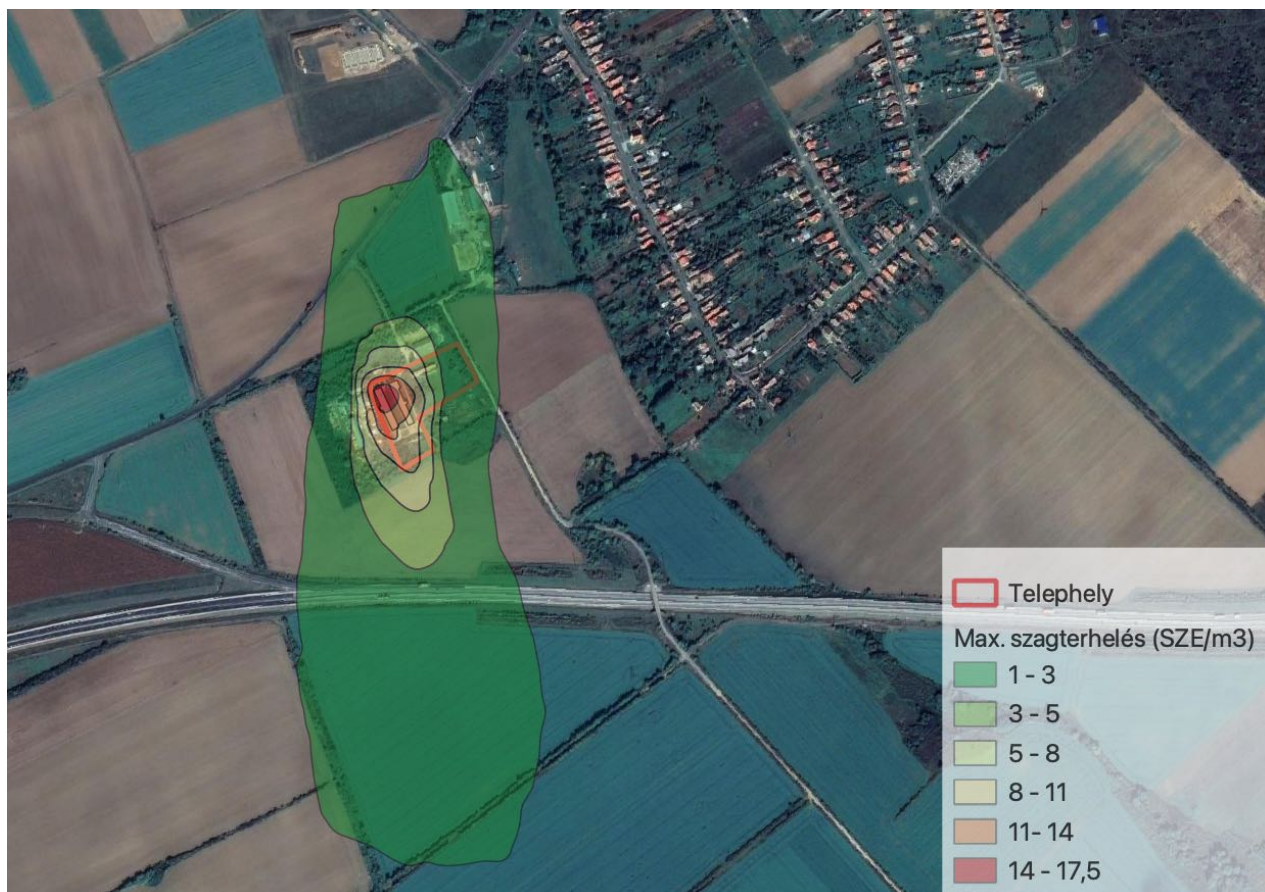
4. ábra Légszennyező anyag kibocsátás terjedési képe (jelenlegi állapot)
