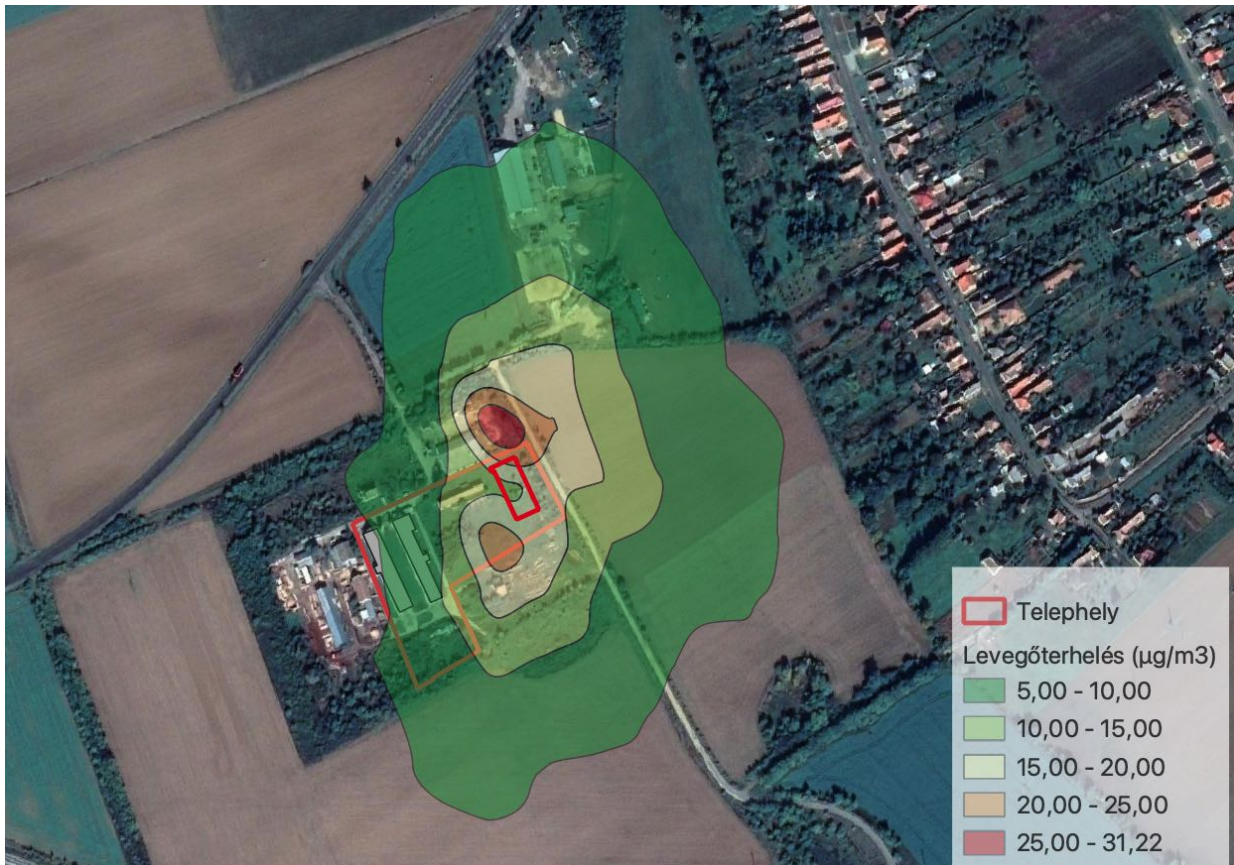
13. ábra PM10 terjedési kép a létesítés fázisában (24 órás)
