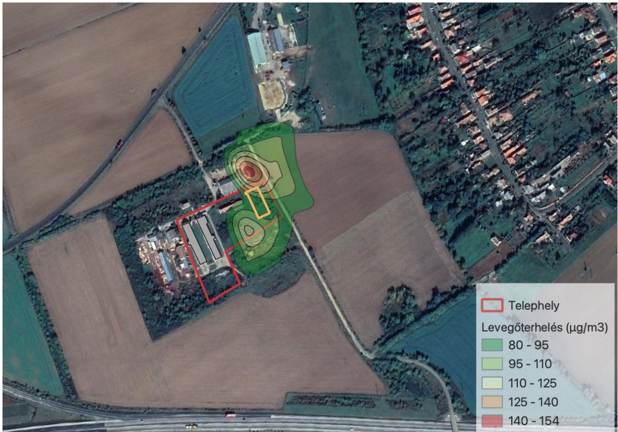
15. ábra Szén-monoxid órás terjedési kép a létesítés fázisában
